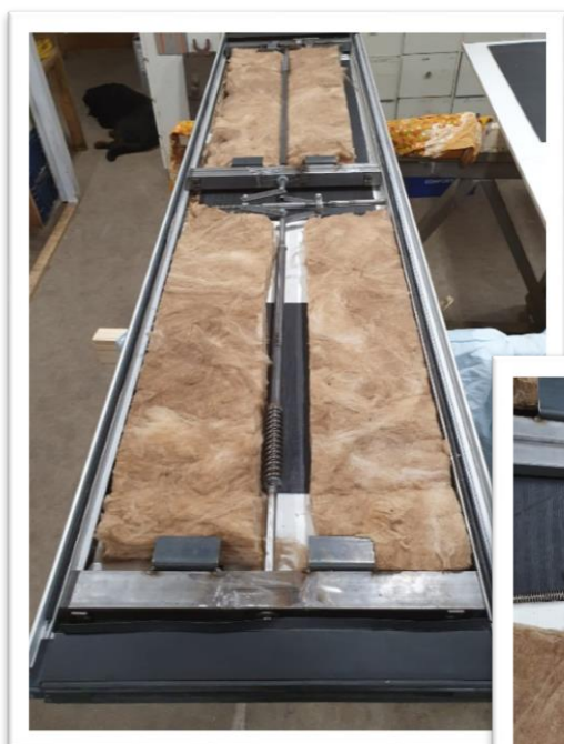
Paneel ingekort, frame gelast en alle onderdelen weer op de juiste plek...
