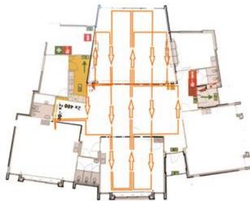
Schematische weergave aanleg ringleiding...
